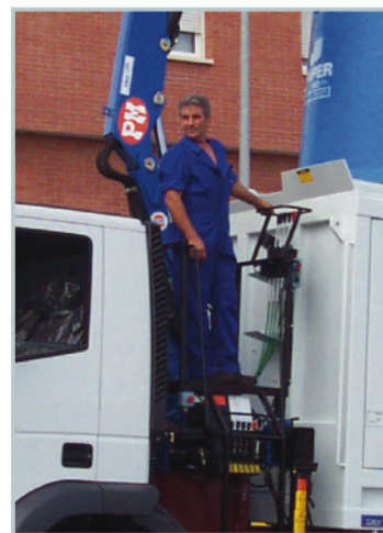
Posto di manovra in piedi: massimo angolo di visibilità. Raised control station: maximum angle of visibility Poste de manoeuvre debout: angle maximum de visibilité. Steuer-Stehplatz Optimal weiter Blickwinkel. Puesto de maniobra en pie: máximo ángulo de visibilidad.
