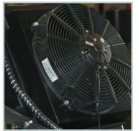
Heat exchanger Cambiador de calor
