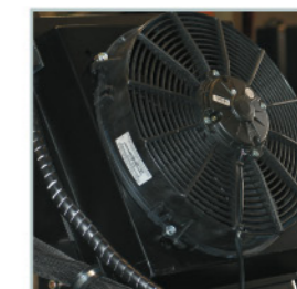
Heat exchanger Cambiador de calor
