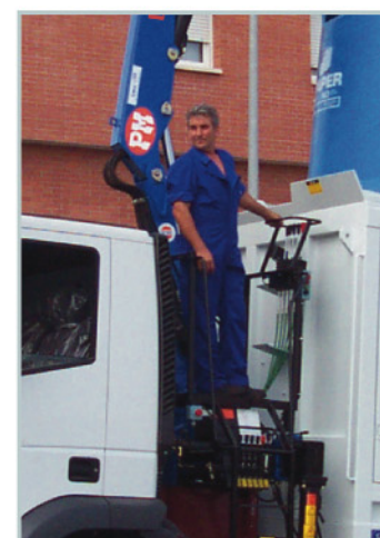
Raised control station: maximum angle of visibility Puesto de maniobra en pie: máximo ángulo de visibilidad.
